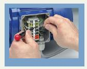
Использование мотор-редукторов Вашег мощностью до 30 кВт с технологией подключения САGE CLAMP® сокращает расходы как на первичный монтаж, так и на сервисное обслуживание.
