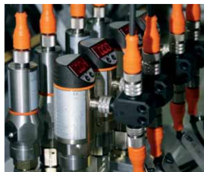
Измерение дифференциального давления при контроле фильтра.
