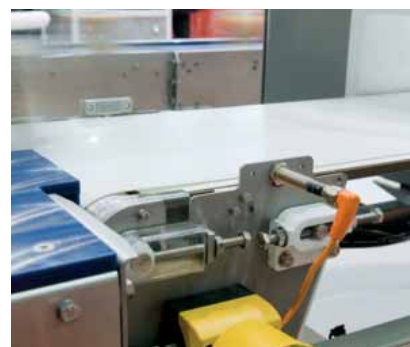
Надёжное обнаружение перемещаемых деталей на конвейерной ленте.
