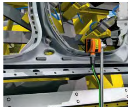
Проверяется наличие клейких подушечек для снижения шума.
