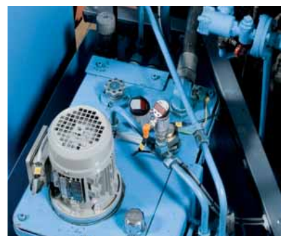
Комбинированное измерение уровня и температуры в компактных гидравлических насосных станциях.
