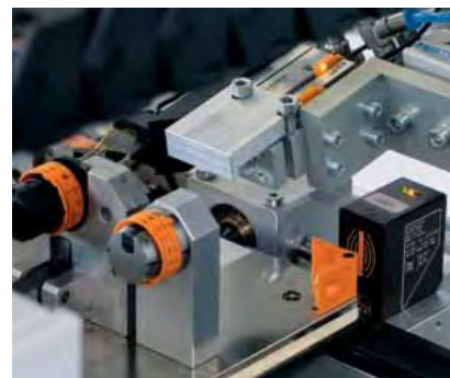
Надёжное обнаружение конечных положений даже для короткоходных цилиндров.
