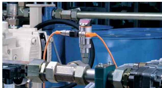
Измерение дифференциального давления при контроле фильтра.
